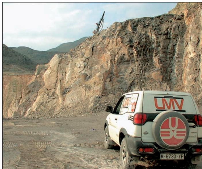
[Figura 4] Perforación de primera fila según diseño tras mediciones iniciales.
