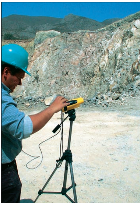
[Figura 2] El técnico de UEE realizando perfilometría láser 2D en el banco inferior de la cantera Buena Vista. Este sistema permite diseñar o evaluar en tiempo real la seguridad de los barrenos de primera fila.
