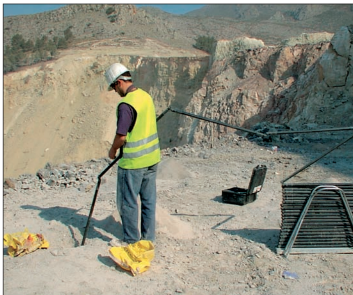
[Figura 3] Medición de posición real de los barrenos de primera fila.
