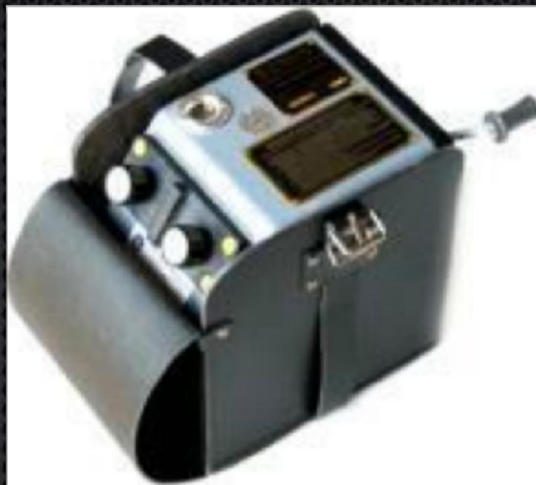
Uno de los explosores más robustos del mercado .Fabricación alemana, con décadas probadas de resistencia y durabilidad. Voltaje condensador:1.800V. Resistencia máxima: 20 dets AI(1510Ohm),400 detsI(750Ohm),600 dets S(15Ohm)
