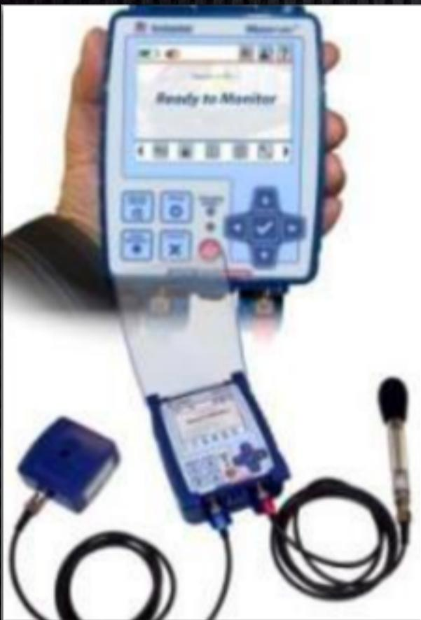
Sismógrafo Instantel Micromate de última generación. Cabe en una mano. Con pantalla táctil y conector USB, ofrece posibilidad de descarga de datos a una memoria USB o directamente al PC. Batería de 10 días de duración. 4 Canales (3 sísmicos y 1 onda aérea). Tiempo muerto cero entre mediciones.
