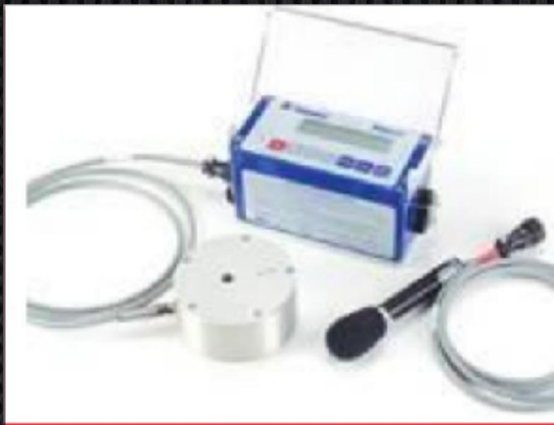
Sismógrafo usado que cumple las especificaciones según norma UNE22-381-93. Con capacidad de memoria de hasta 300 mediciones y 4 canales. Incluye base con picas de anclado al terreno, cable de conexión a PC, adaptador de corriente y de impresora. Es un modelo con tiempo muerto cero entre mediciones (voladuras consecutivas quedan registradas), más de 500 segundos de grabación, modo de auto disparo, hasta 4 kHz de frecuencia de muestreo. Se entregan calibrados y con un año de garantía.
