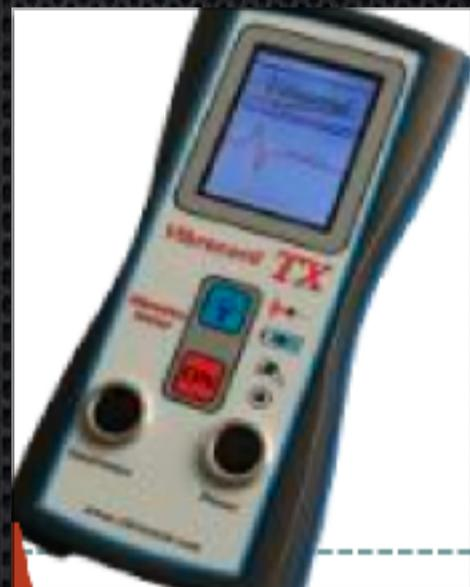
El sismógrafo digital Vibracord compara de forma inmediata el registro con los criterios de industria. De fácil manejo, económico y robusto, cumple con las especificaciones de la norma UNE22.381. Para extras y accesorios consultar precios. Modelo Vibracord TX de muy fácil manejo, pantalla de 2,5" con panel táctil, fácil e intuitiva. Los datos se guardan en una tarjeta SD
