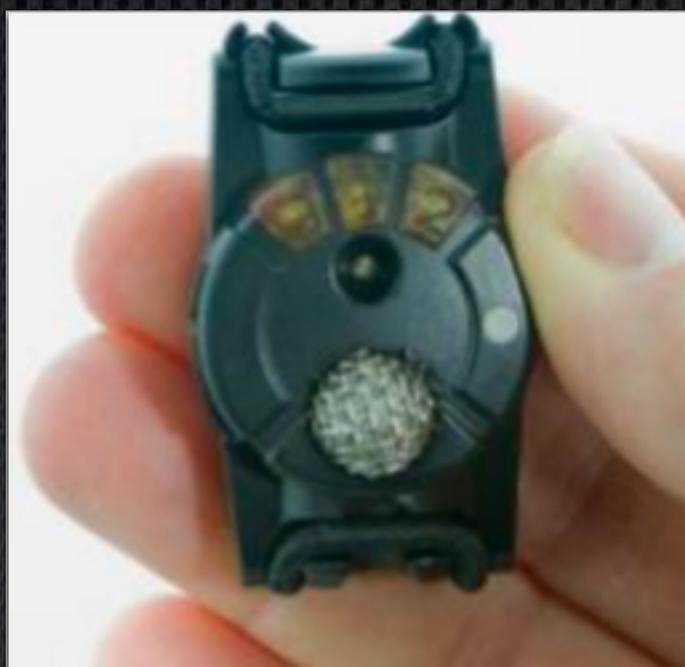
Sistema de detección de daños a persona producidos por las sobrepresiones de onda aérea producidas por voladura. Diseñado conjuntamente con las fuerzas especiales de seguridad de Estados Unidos, está especialmente indicado para detectar de manera precoz los posibles daños internos, distinguiendo entre sucesos moderados o graves. Almacena automáticamente la información acerca de las sobrepresiones experimentadas para facilitar su posterior análisis. Consultar precios por número de unidades.
